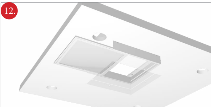
12. Az álmennyezet sziget ezen célra kialakított fiókján keresztül csúsztatjuk be a keretbe a LED panelt
